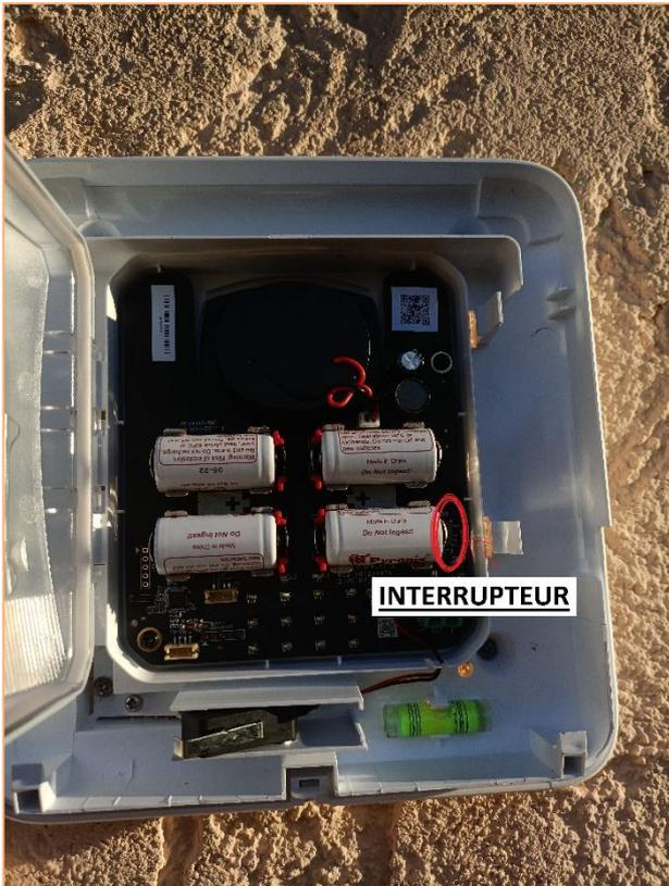
Mettre l'**interrupteur** sur ON
