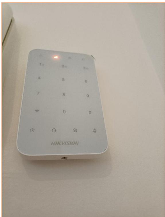
Enclenchez correctement le clavier avec son couvercle fixé au mur et serrez la vis du dessous
