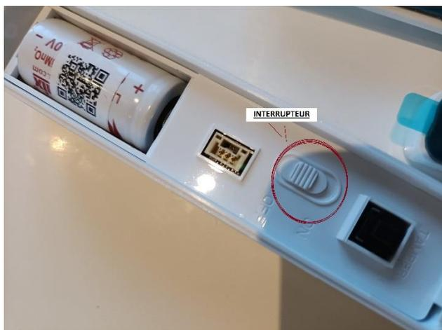
Mettre l'**interrupteur** sur ON
